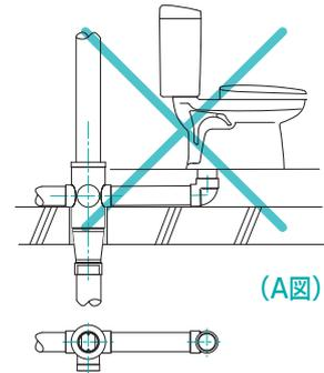
▲ アクロスジョイントに便器を接続した場合、他器具との排水を対面方向で合流させると便器排水が対向口に流入し、他器具のトラップに悪影響を及ぼす危険性があります。A図のような『便器の対向口に他の器具を接続する配管』につきましては、アクロスジョイントは使用出来ません。参考B図の配管形態をお勧めいたします。但し、便器の種類・配管形状により異なりますので弊社までご相談ください。
