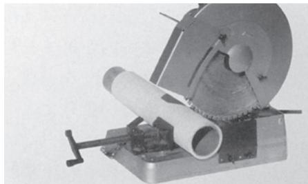
標線の箇所を管軸に対して直角に切断します。切断にはチップソー・バンドソー、手鋸等を用いてください。
