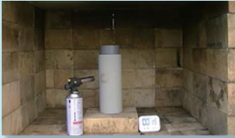
文字通りの耐火性能で煙の発生を抑え、避難時間の確保に貢献し、人命を守ります。火災の程度にもよりますが、内管の塩ビ管は残るため、一時的な上階からの排水が可能です。
