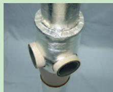
床防水処理後(最終項※1)、上部遮音パーツの折り返しを元に戻し、スリット部及びスラブとの隙間をALGCテープ等で仕上げます。
