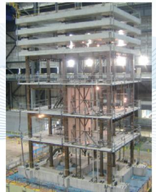
「Eディフェンス(実大三次元震動破壊実験施設)」による配管テストでもフネンパイプの耐震性の高さが確認されました。
