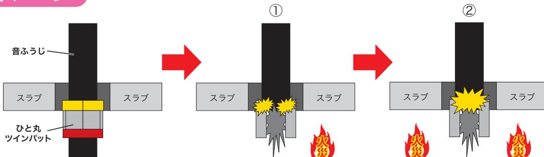
① 火災が発生すると膨張セラミックシートが内側に膨張。アルミガラスクロスと共に外周材を形成し、塩ビ管の脱落回避と自己閉塞の助力となります。
