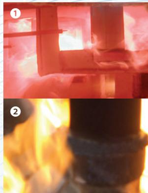
(一財)建材試験センターでの「フネンパイプ耐火試験」の様相(写真①)と社内における「メジフリー継手の燃焼(目地材の熱膨張)実験」の様相(写真②)です。
