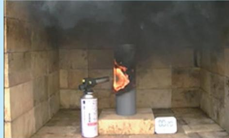
数秒で黒煙や有害ガスが発生します。樹脂系パイプ全般がこのような結果となります。最終的に塩ビ管は炭化して上階からの排水ができなくなります。
