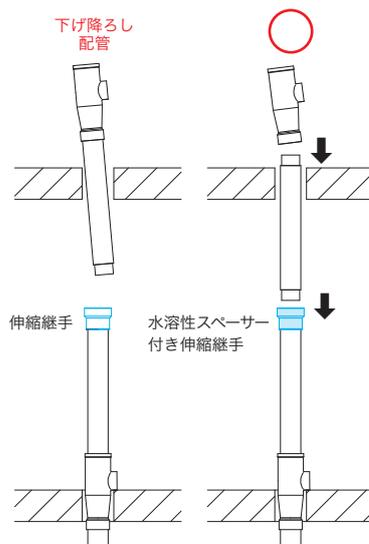
下げ降ろし配管(推奨)が難しい環境でも確実な伸縮継手の設置が可能になります。
