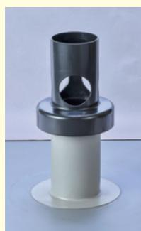
※通気管に接着する部分は75用100用で60mm、125用で65mmとなっているためすべて挿し込んで接着してください。
