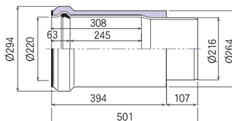
※基準挿入寸法 = 210 mm
