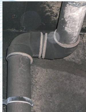
実際の火災後の現場写真。配管が保持され、継手に組込まれている熱膨張目地材が膨張し、接合部の隙間を塞ぎ有害ガスの漏洩を防いでいます。
