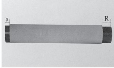
切断後、プラスチックハンマー等で再度内管をスライドし、外管の両側に所定の挿入しろと接着しろがでるようにします。
