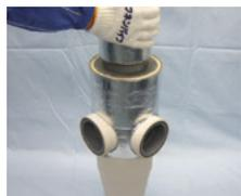
②で寸法調整した直管の下流側内管(塩ビ管)をゴムリングストップパー部分まで挿入しマーキングの位置を確認します。
