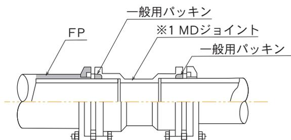
※1 MDジョイントは排水鋼管継手工業会規格の排水鋼管用可とう継手です。
