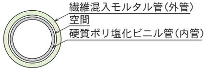
B) 外管と内管の間にスライド材を入れた構造
