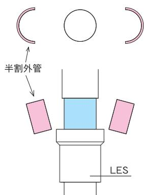
① 塩ビ管露出寸法に合わせた直管外管を縦方向に切断して半割を作り、塩ビ露出部に半割外管を被せます。
