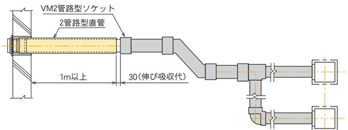
1. 共同住宅の用途で一定の条件を満たす場合、VM2管路管と換気用フネンパイプを併用できます。接合は、VM2管路型ソケットをお使いください。
