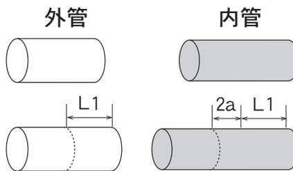
● 定尺管を切断した後、残った管を切断する場合、短尺管から内管を引き抜き、分離します。
