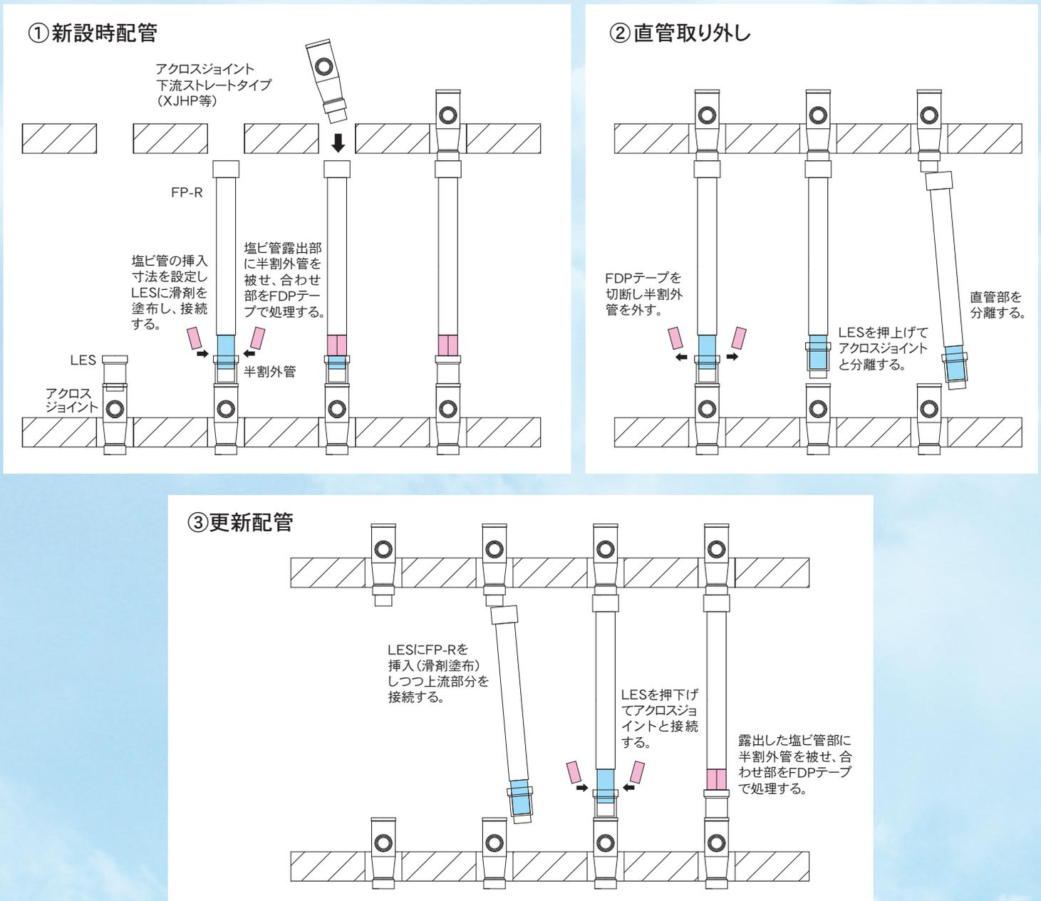
上記は「アクロスジョイントストレートタイプとフネン受口付きパイプ（FP-R）による配管更新の一例です。鋳物単管式継手（ストレート・フランジ）との接続などにつきましては別途お問合せください。
