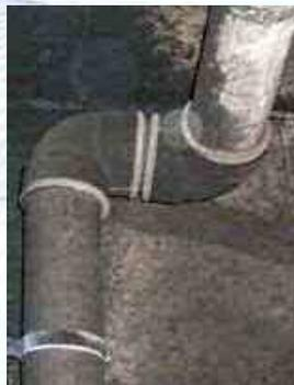
実際の火災後の現場写真。配管が保持され、継手に組み込まれている熱膨張目地材が膨張し、接合部の隙間を塞ぎ有毒ガスの漏洩を防いでいます。
