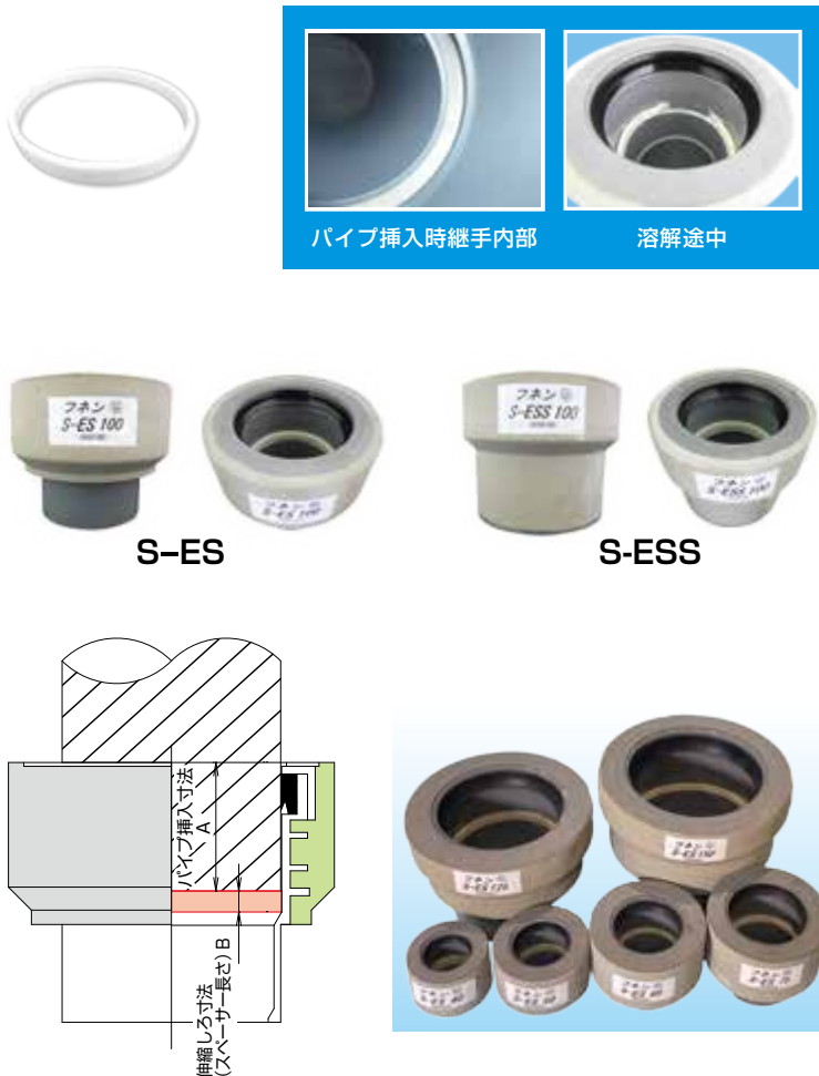
パイプ挿入時イメージ (S-ES、S-ESS共通)
