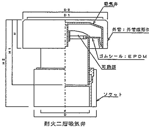
耐火二層吸気弁の標準寸法 単位 mm
