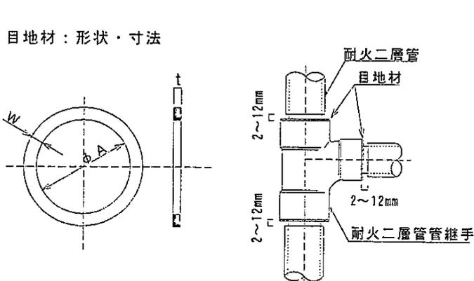
熱膨張性目地材の標準寸法
