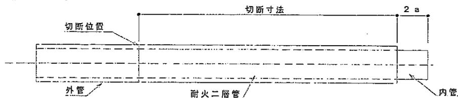
③標線を記入した切断箇所を管軸に直角に切断する。切断には金のこ又はバンドソーなどで切断する。管継手に挿入する内管の挿入代  $a$  は下表の通りである。
