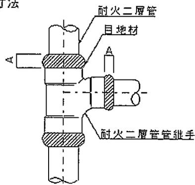
けい酸ナトリウム系目地材の標準寸法
