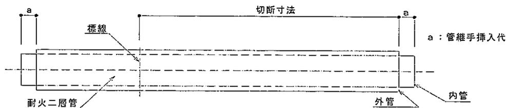
②次に内管を片側に管継手挿入代の2倍だけ内管をプラスチック製ハンマーなどで痛めないように移動する。
