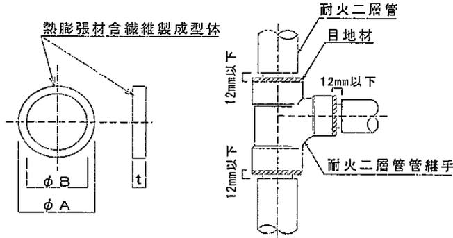
熱膨張材含繊維製目地材の標準寸法
