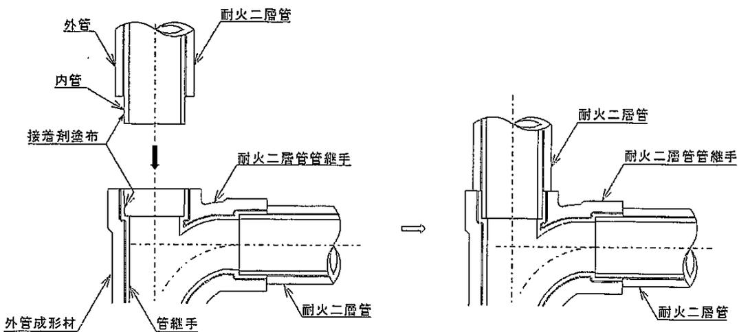
(5) 耐火二層管と目地処理を必要としない目地材付耐火二層管管継手の接続
